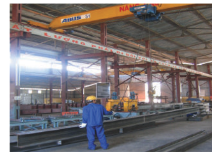
岷港自动焊接钢梁及结构制造车间
