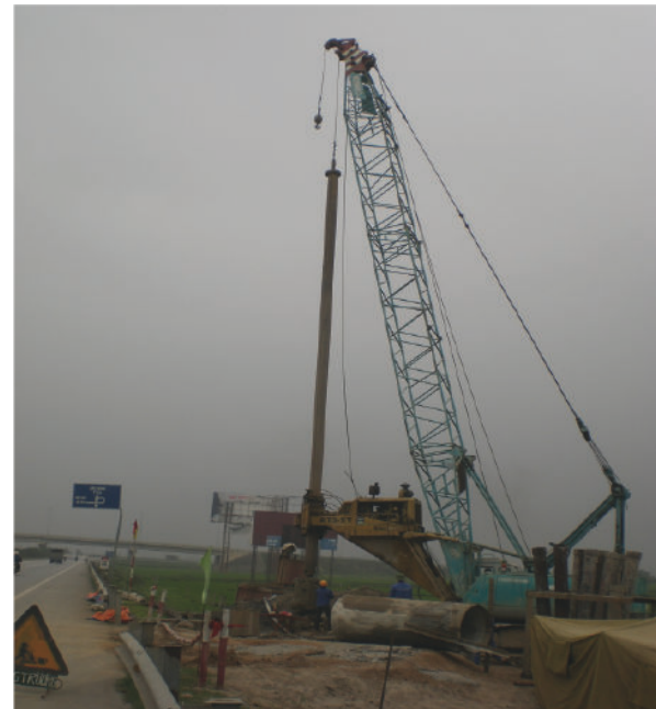
神钢 BM500 旋挖钻机 Kobelco BM500 rotary drilling rig
