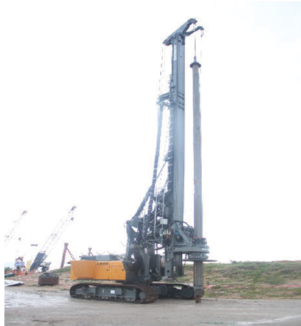
Máy khoan cọc nhồi Liebherr LB28 Liebherr LB28 rotary drilling rig
