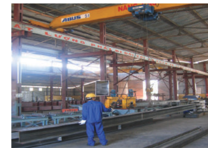
Xưởng chế tạo dầm và kết cấu thép, công nghệ hàn tự động tại Đà Nẵng
