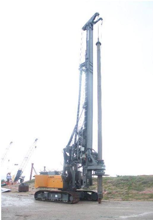
Máy khoan cọc nhồi Liebherr LB28 Liebherr LB28 rotary drilling rig
