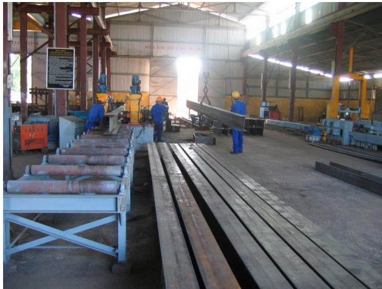
Xưởng chế tạo dầm và kết cấu thép, công nghệ hàn tự động tại Huế Steel girders and structure production workshops with automatic welding technology in Hue
